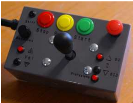
Controllo remoto per il movimento degli assi ed il controllo delle funzioni di lavoro.
