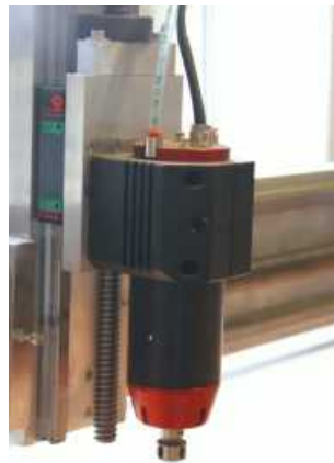
Elettromandrino ad alta frequenza raffreddato a liquido ed il relativo compressore di raffreddamento.
